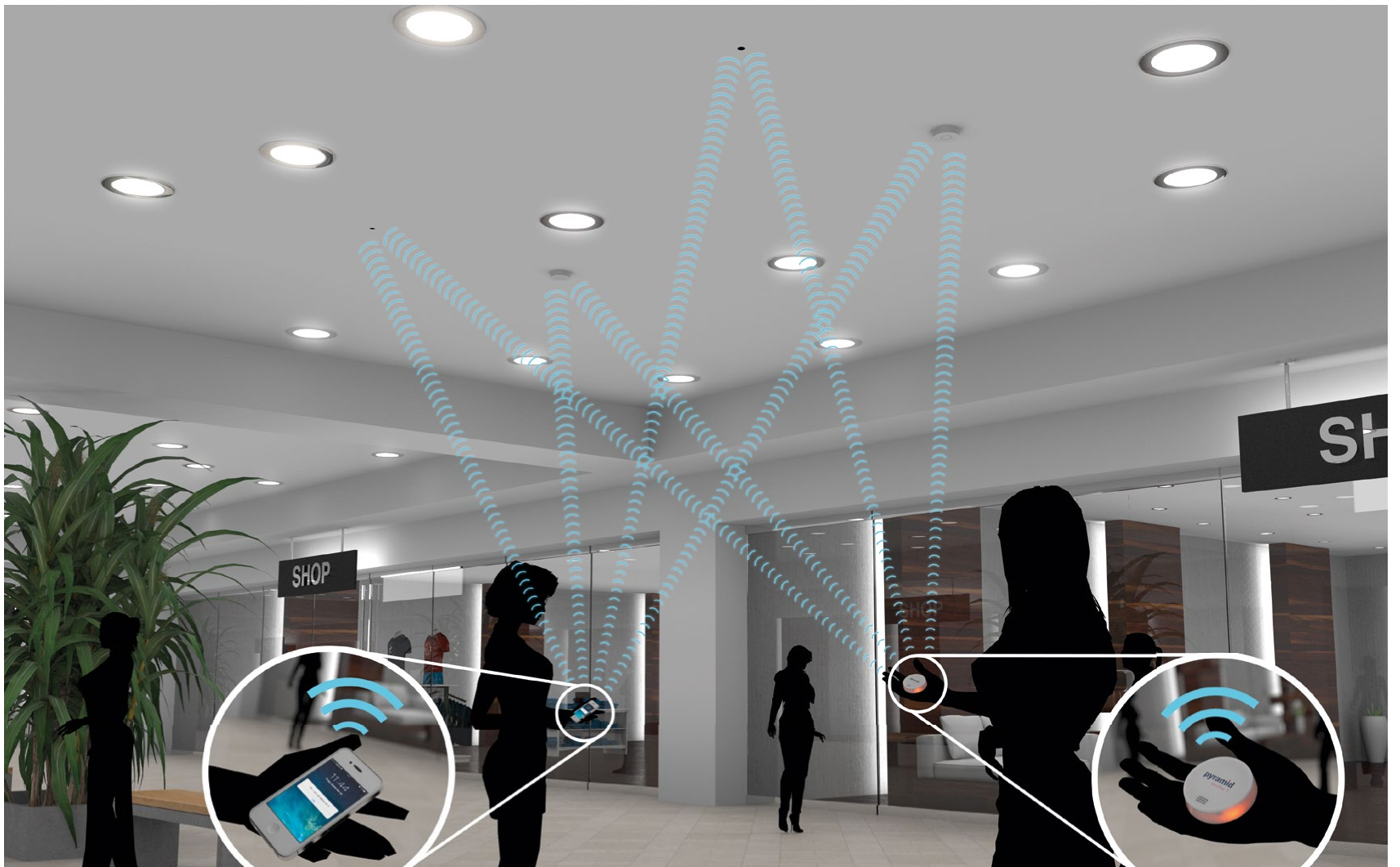
PLS ermöglicht eine regalgenaue Ortung im Handel bzw. eine platzgenaue Ortung in der Gastronomie. Als Ultraschallsender kann wahlweise ein handelsübliches Smartphone oder ein Puck eingesetzt werden.
